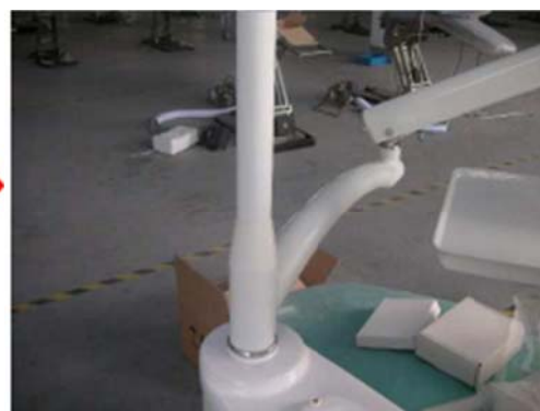
Установите штангу светильника на штангу для крепления
